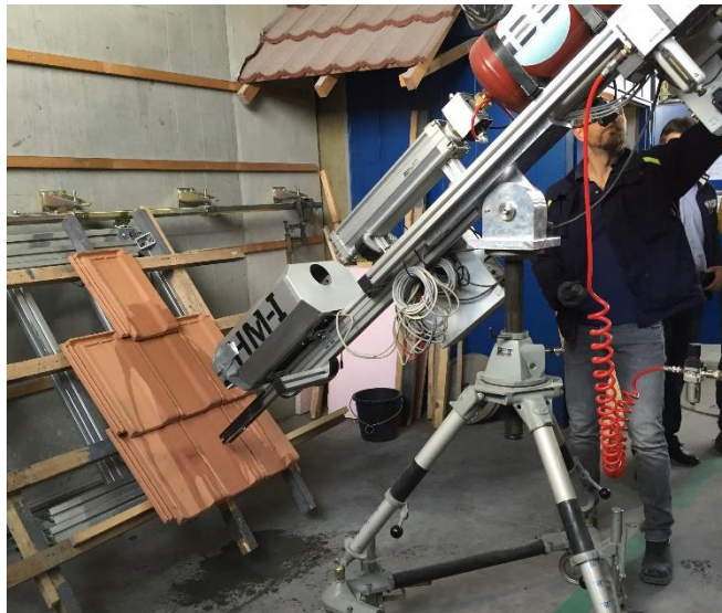
Illustration 3 : Contrôle de la résistance des tuiles à la grêle dans un laboratoire d'essai.
